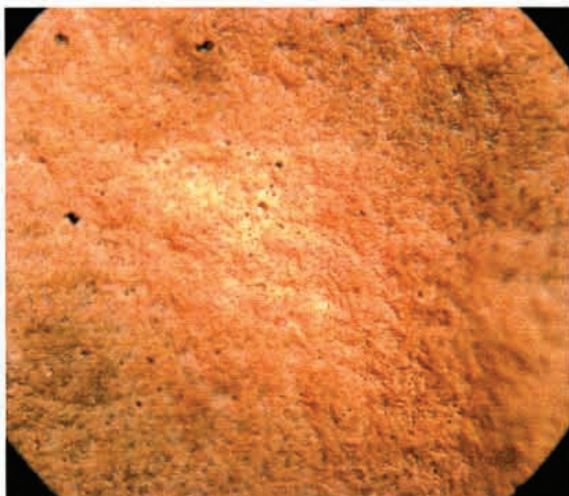
Foto 4 - Campione "Impasto 1". Particolare della superficie vista a 30 ingrandimenti.
